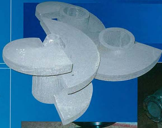
Corpo de extrusora - 12 000Kg
