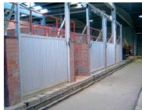
■ Fornos de túnel ■ Hornos tunel ■ Tunnel kilns ■ Туннельные печи
