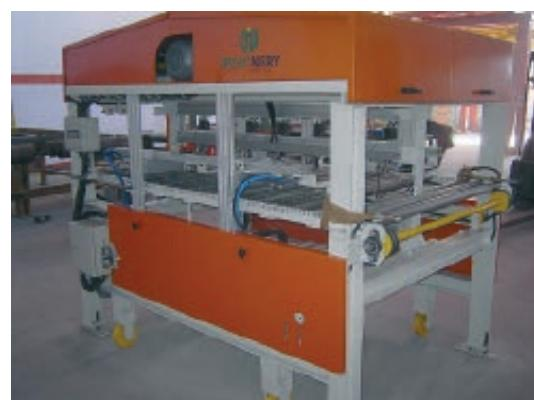
Cortador multifio para tijolo furado de construção
