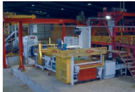
Cortador multifio para tijolo cara à vista
