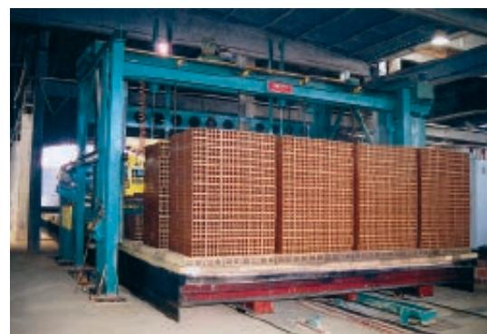
■ Secadores de túnel ■ Secaderos tunel ■ Tunnel dryers ■ Сушильные печи туннельные
