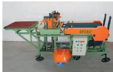
Cortador modelo AE-600 próprio para tijolo maciço em grandes produções, adaptável para telha curva.
