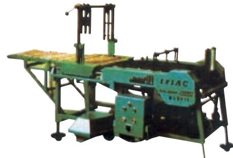
Cortador multifio para tijolo manchenbrado
