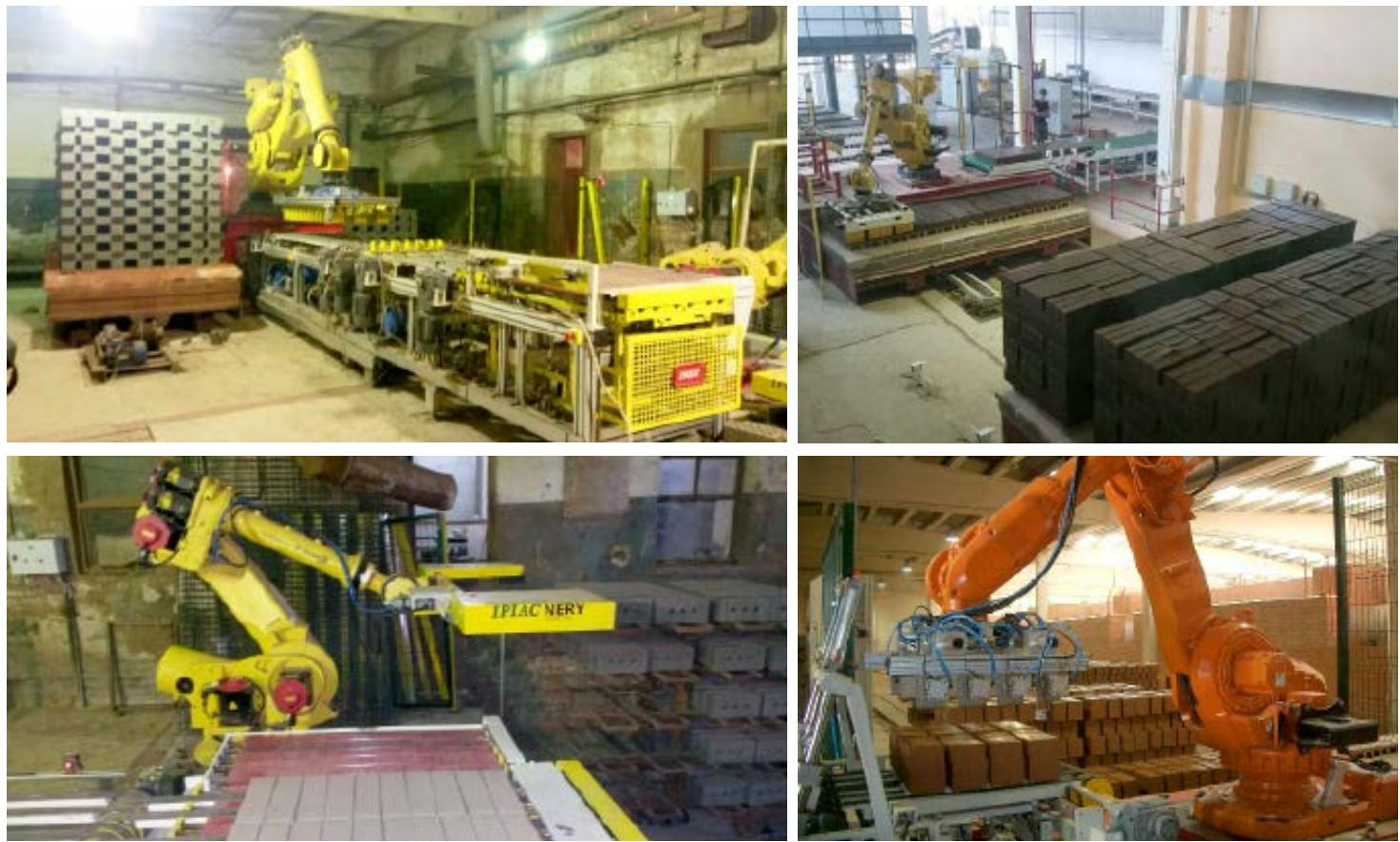
• Carga/descarga de tijolo • Carga/descarga de ladrillo • Load/unload of bricks • Погрузка/разгрузка кирпича
