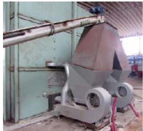
Os nossos queimadores de combustíveis sólidos, são essencialmente constituídos por: tolva de carga do combustível, sem-fim condutor do combustível à zona de queima, cachimbo de chegada e subida do combustível, módulo de grelhas em ferro fundido, ventilador e conduitas de ligação às partes inferior e superior das grelhas e conjunto de accionamento com dois comandos independentes (um para o sem-fim outro para o ventilador).
